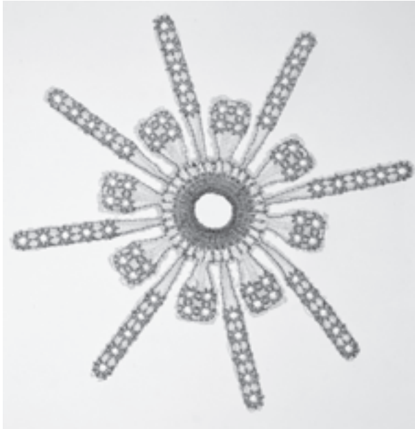
34 Machinaal geborduurd implantaat van polyester hecht draad voor herstel van een door kanker aangetaste schouder, ontwikkeld door Ellis Developments Ltd., Nottingham, 2004. Ter beschikking gesteld door Ellis Developments Ltd.
